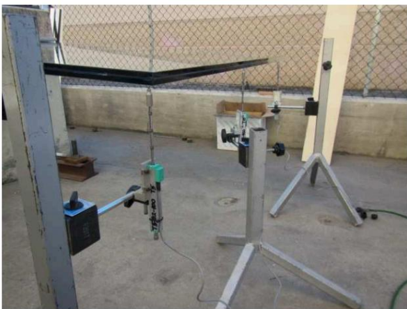
Zdjęcia rozmieszczenia przyrządów do pomiaru przemieszczeń
