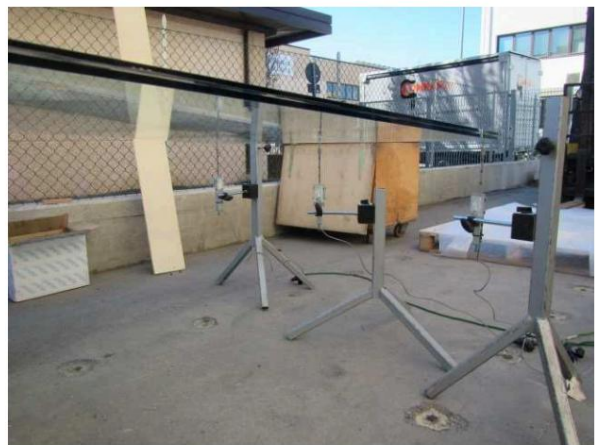
Zdjęcia rozmieszczenia przyrządów do pomiaru przemieszczeń
