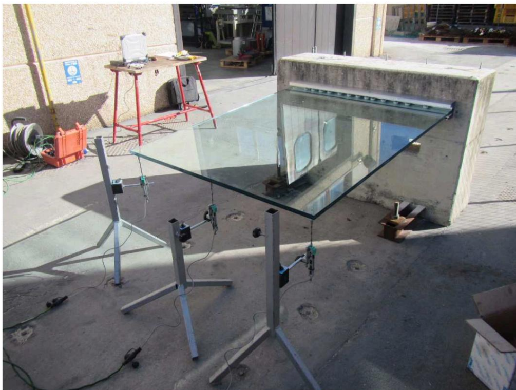
Zdjęcia rozmieszczenia przyrządów do pomiaru przemieszczeń
