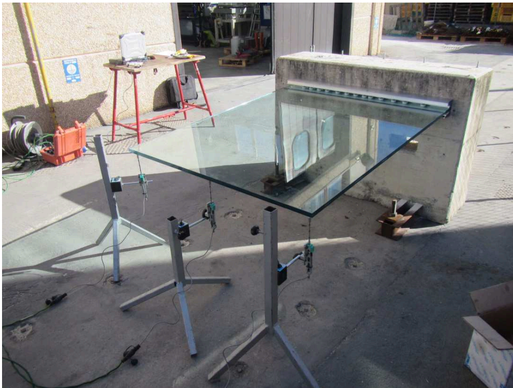
Fotografie della disposizione degli strumenti di misura dello spostamento
